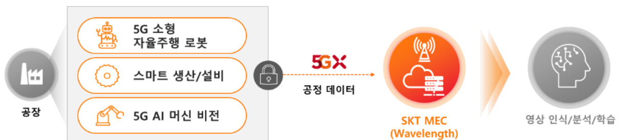
[그림 2-2-11] 스마트 팩토리 MEC 적용을 통한 보안 전송
