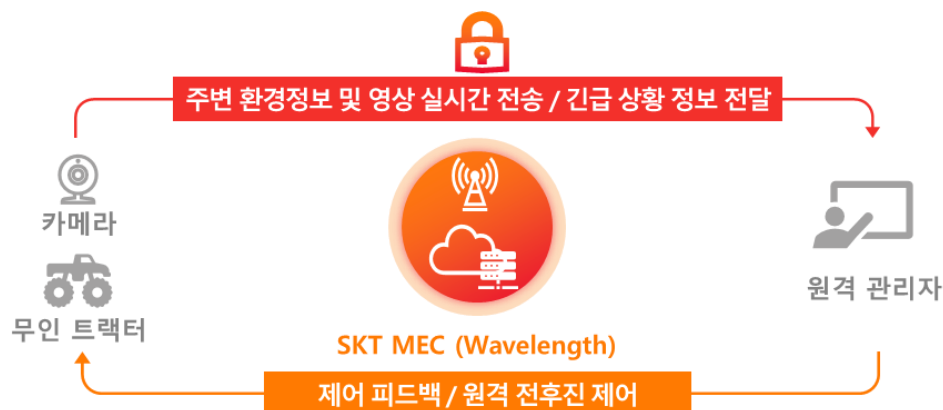
[그림 2-1-11] 무인 자율주행 트랙터 MEC 적용 구조도
