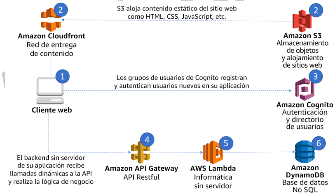
Figura 6: Arquitectura de referencia para una aplicación web
