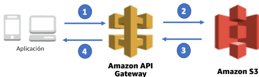
Figura 29: Sondeo del cliente para actualizaciones de transacciones realizadas recientemente
