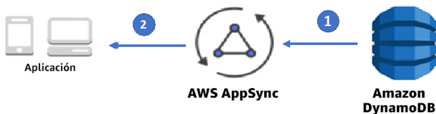
Figura 27: Actualizaciones asíncronas a través de WebSockets con AWS AppSync y GraphQL
