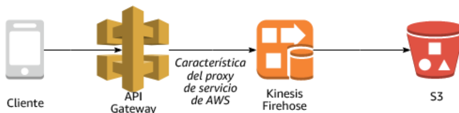
Figura 31: Reducción del costo de envío de datos a Amazon S3 mediante la implementación de un proxy de servicio de AWS
